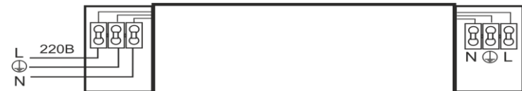
Рис. 4. Подключение СТЕП ПН к сети 220В
