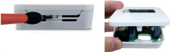
Осторожно снимите переднюю панель и подключите провода.
