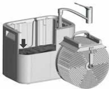
Наполните нижнюю часть прибора водопроводной водой (примерно 9 л) не более чем до середины поддона.
